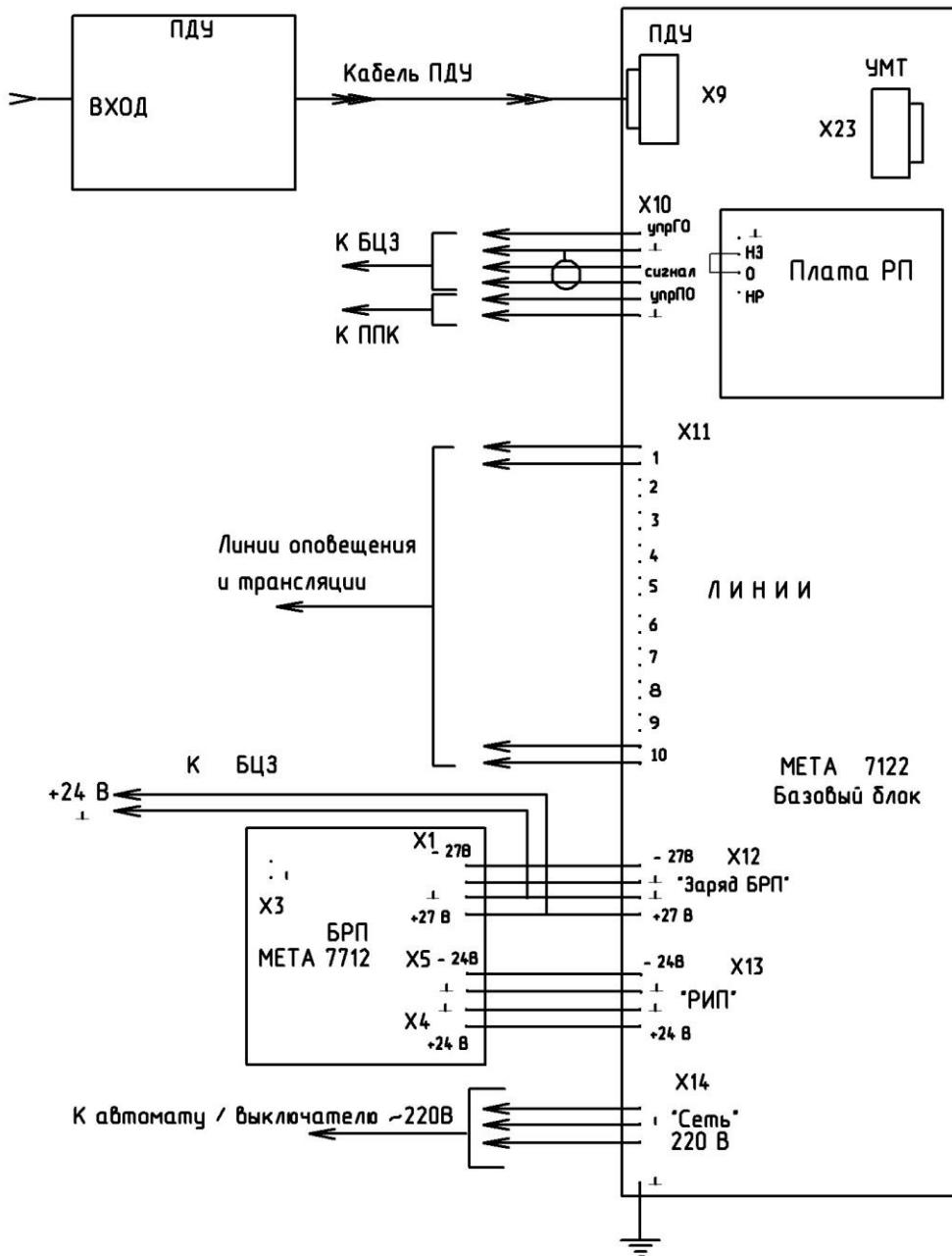
Рис.2. Схема подключения МЕТА 7122 без блока расширения
