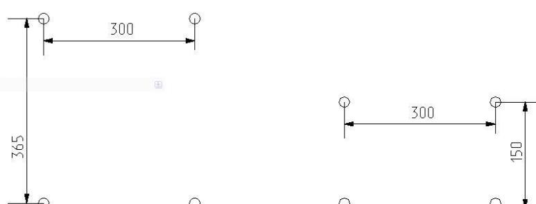
При размещении блоков УМ расстояние между ними должно быть порядка 150-300мм, так как соединяющий их кабель имеет длину всего 1,2м. БРП размещаются над блоками усилителя
